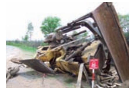
大型地雷引发的重型机械损害
